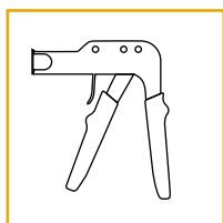
narzędzie zaciskające do kołków typu Molly
